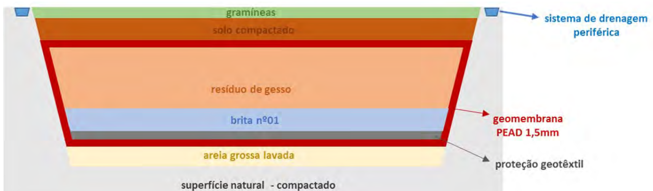
Figura 22 Esquema básico de fechamento do Aterro Industrial H1
