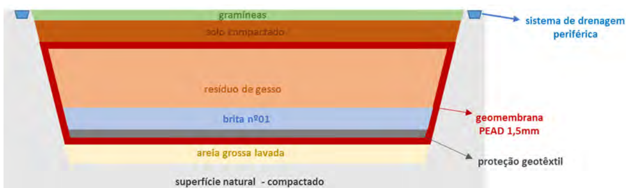
Figura 10 Esquema básico de fechamento do Aterro de Resíduos Industriais H1.
