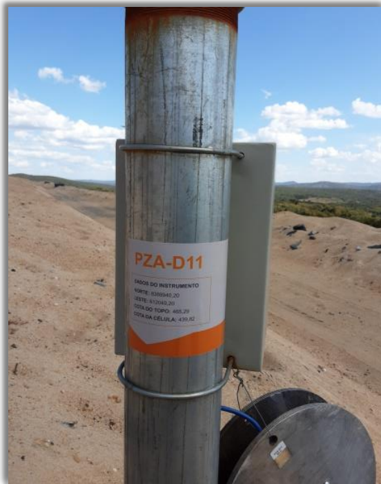
Figura 13-8: Piezômetro automático instalado no corpo da barragem
