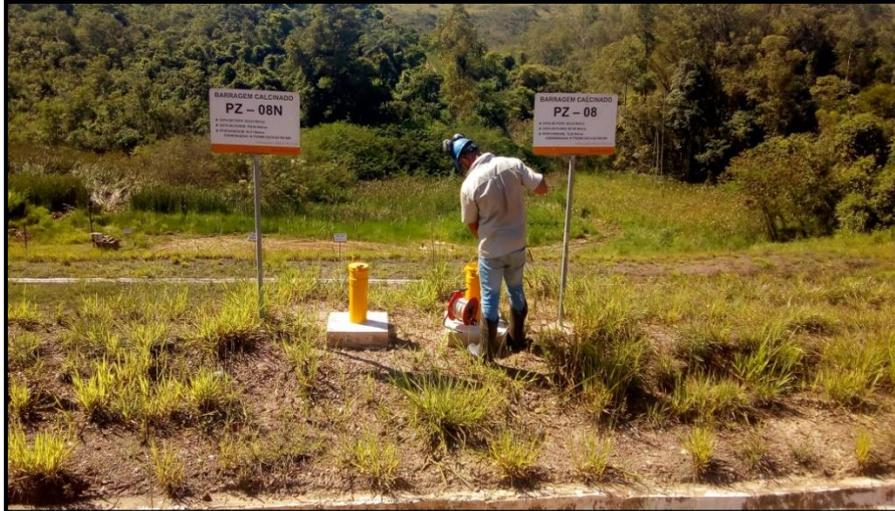
**Figura 13-4: Leitura do Piezômetro PZ-08 barragem de Calcinados**
