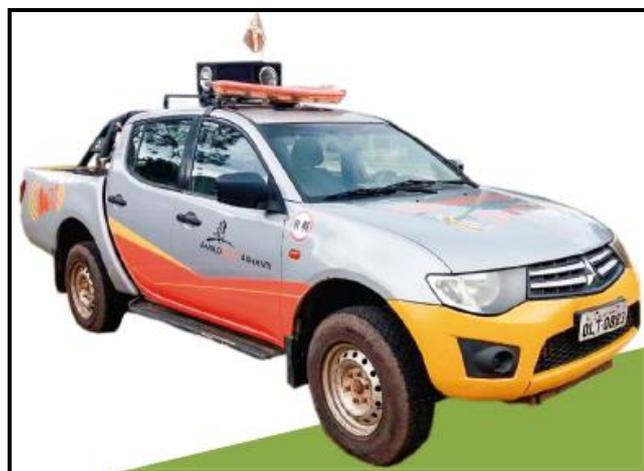
**Figura 8-6: Sirene móvel instalada em veículo de apoio**
