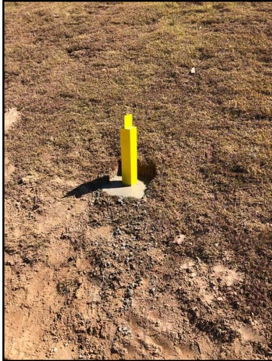
**Figura 13-2: Exemplo de marco superficial na Barragem de Calcinados**
