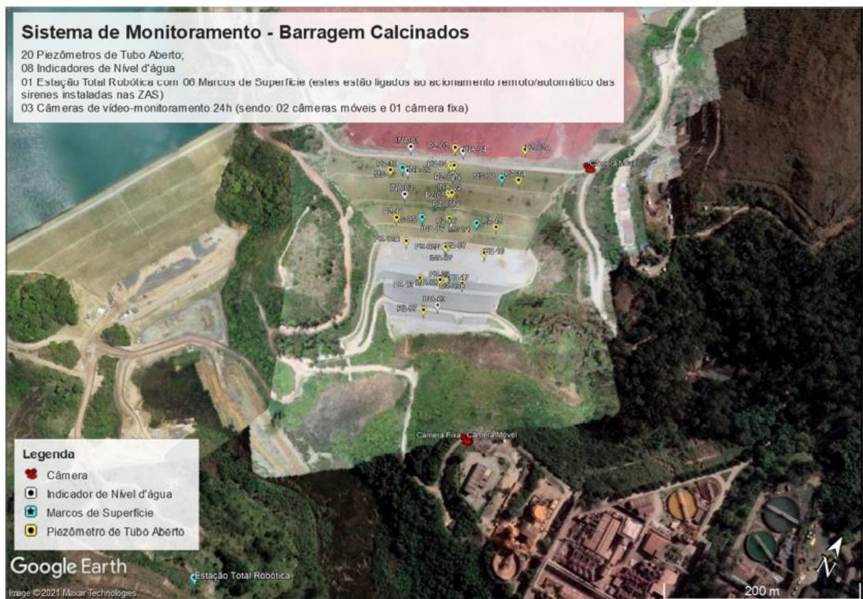
**Figura 13-1: Sistema de Monitoramento – Barragem de Calcinos**
