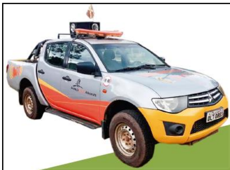
Figura 8-6: Sirene móvel instalada em veículo de apoio
