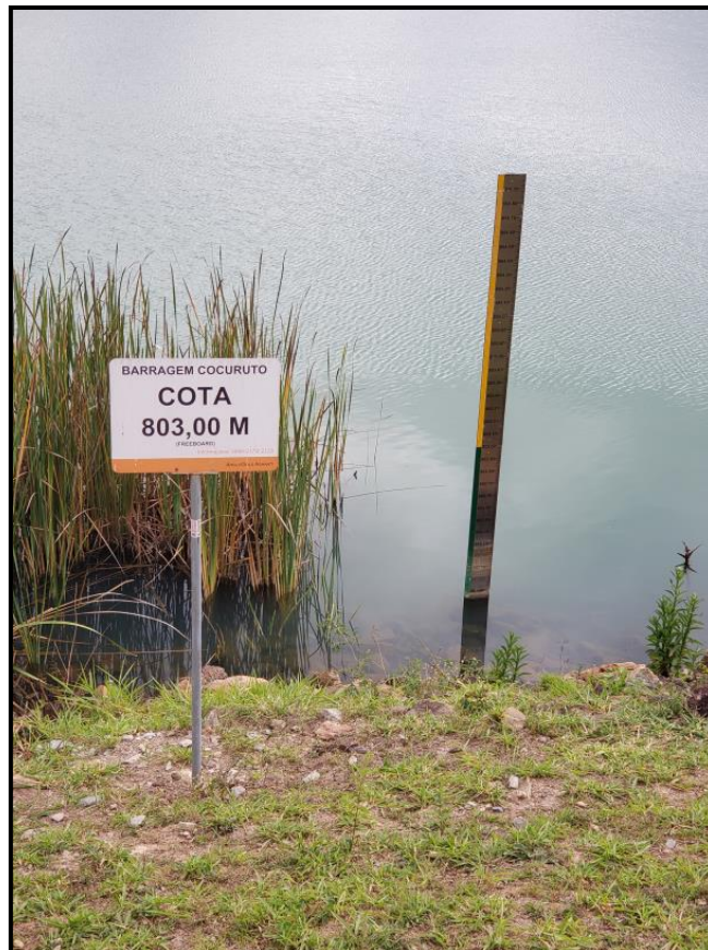
Figura 13-3: Régua graduada instalada no reservatório - barragem Cocoruto
