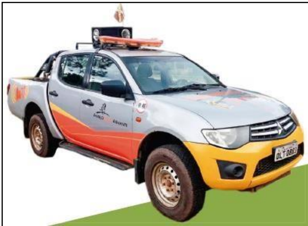
Figura 8-5: Sirene móvel instalada em veículo de apoio
