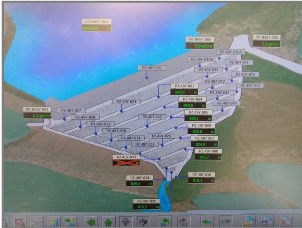
Figura 13-6: Tela de monitoramento dos piezômetros automatizados
