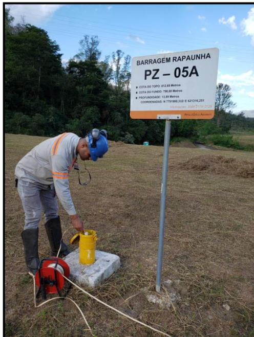
**Figura 13-4: Leitura do Piezômetro PZ-05A - Barragem Rapaunha**
