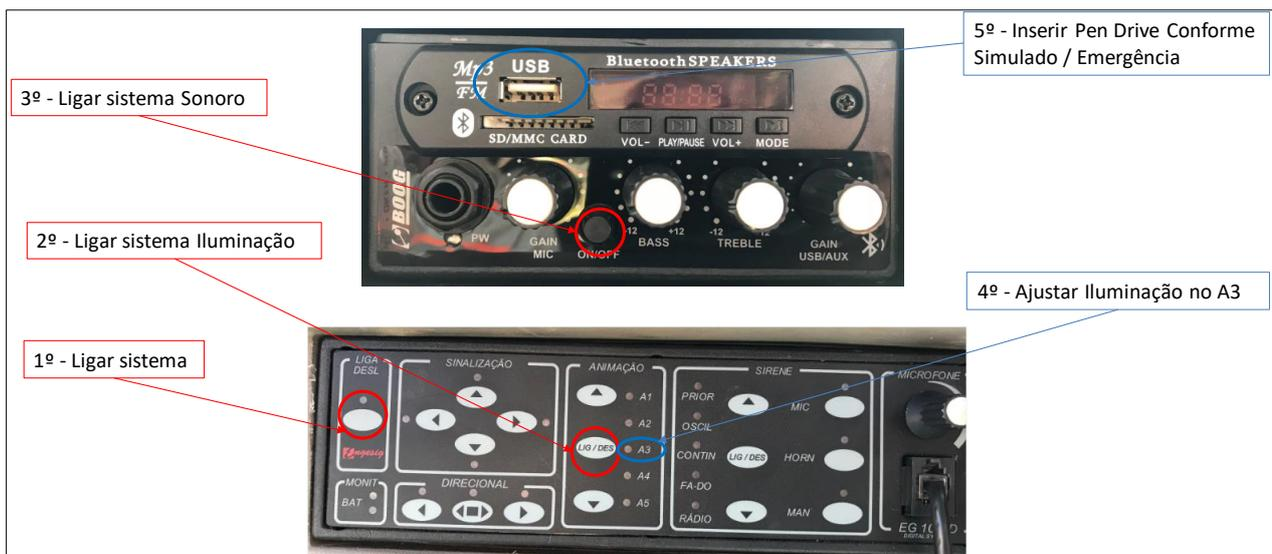
**Figura 8-6: Acionamento do sistema de sirenes no veículo de apoio.**
