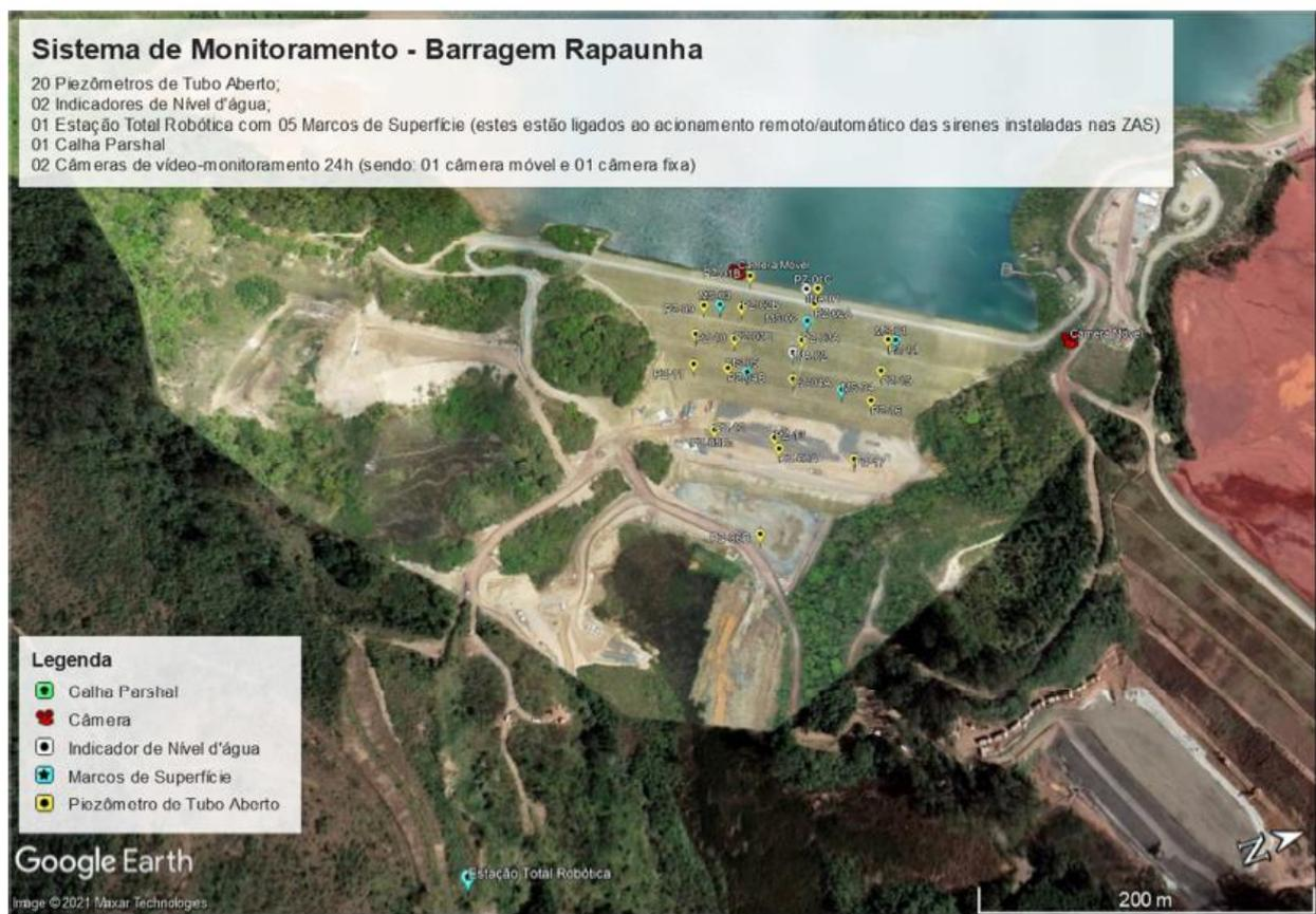
**Figura 13-1: Sistema de Monitoramento – Barragem Rapaunha**
