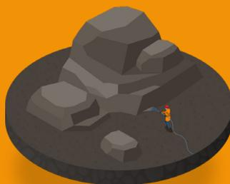
**5** São aplicados **tirantes**, que são como grandes parafusos, para fazer o travamento do teto. De acordo com o planejamento e as necessidades geológicas da mina, é feita a contenção com **concreto e telamento**.
