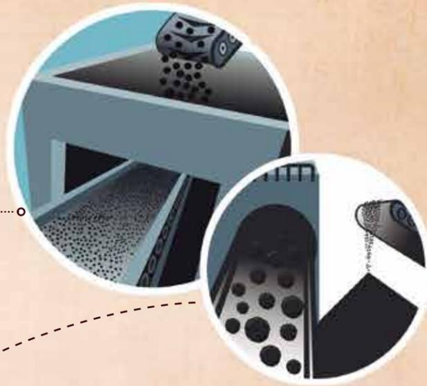
O material moído contém vários minerais além do ouro. Para separar as partículas de ouro dos outros minerais que não possuem valor econômico, o material é submetido ao que chamamos concentração, que se divide em dois processos distintos: concentração gravítica ou gravimétrica (minerais de alta densidade) e flotação (processo de separação de misturas em que os minerais de interesse – sulfetos – aderem-se às bolhas de ar).
