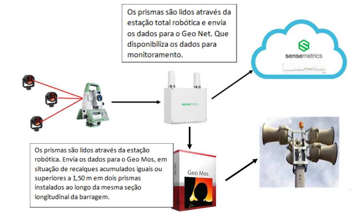
Figura 13-12: Esquemática de acionamento automático das sirenes
