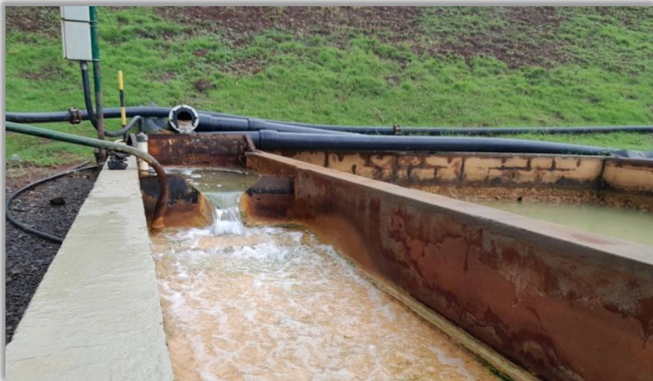
Figura 13-10: Medidor automático de vazão de dreno da barragem instalado junto da calha parshal
