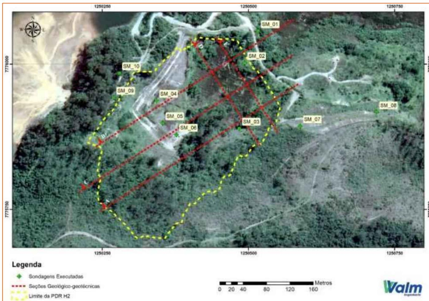
**Figura 8-13 - Localização das sondagens e seções geológico-geotécnicas**
