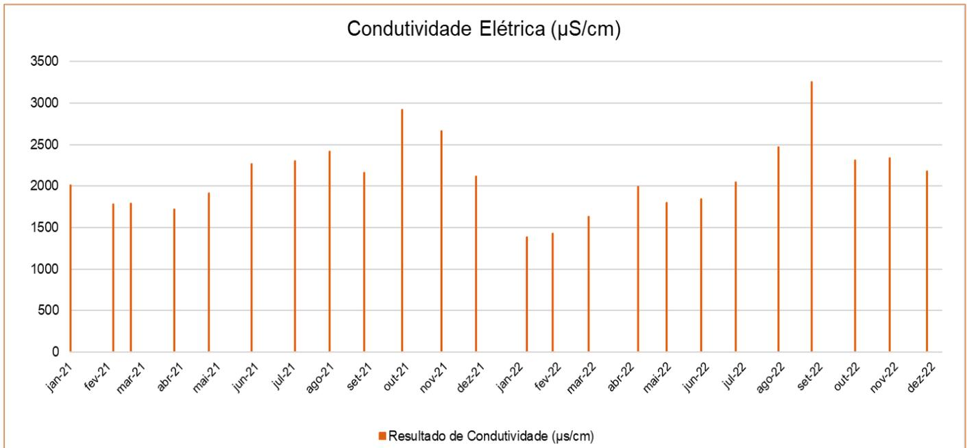
**Figura 11-97 - Gráfico de resultados de Condutividade Elétrica no ponto de monitoramento de efluentes**
