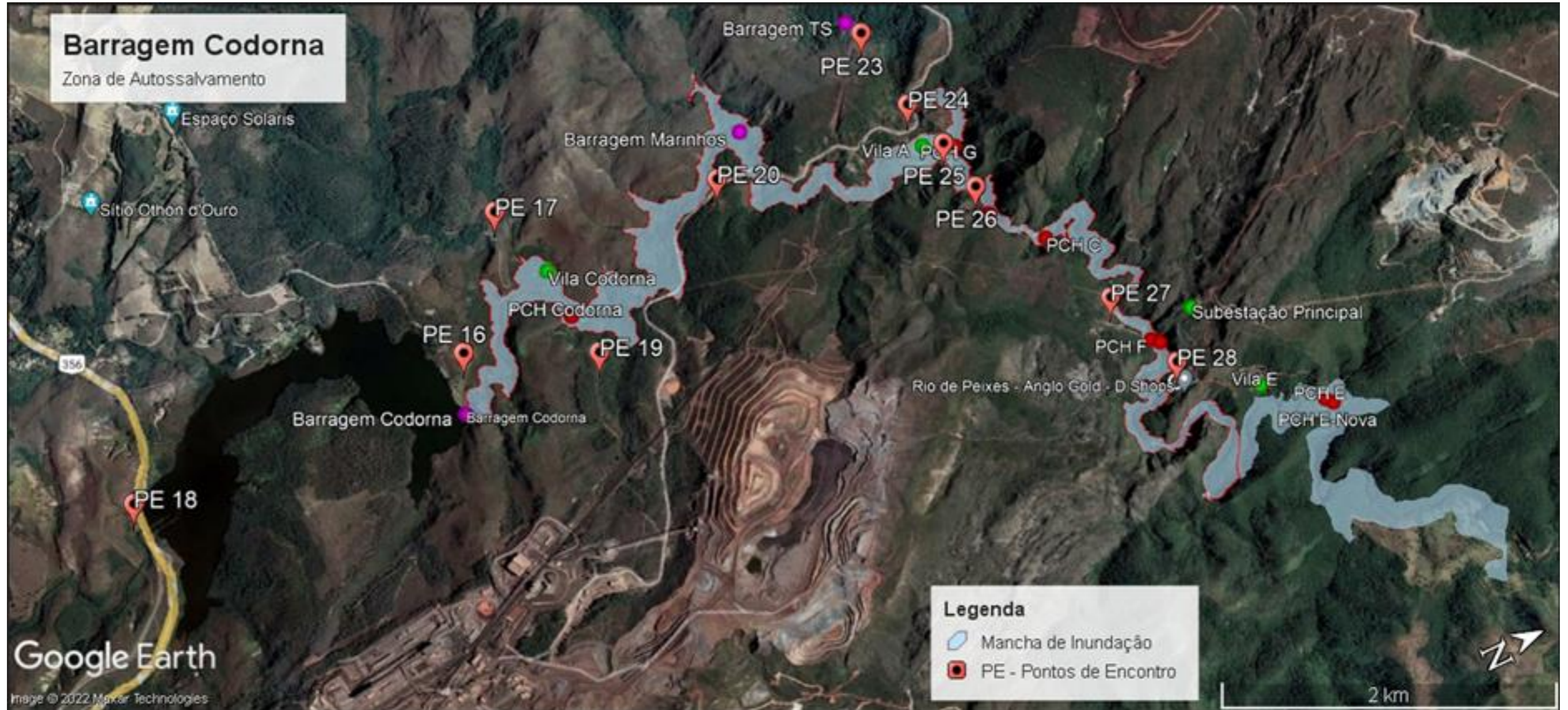
Figura 16: Mapa dos Pontos de Encontro e rotas de fuga nas zonas de autossalvamento
