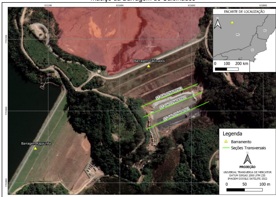
Figura 12 - Seções transversais para avaliação da ruptura hipotética da Barragem de Rapaunha sobre o maciço da Barragem de Calcinados
