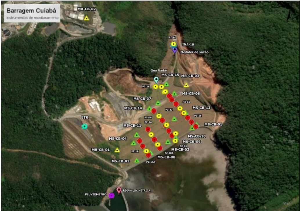
Figura 14: Sistema de Monitoramento da Barragem Cuiabá
