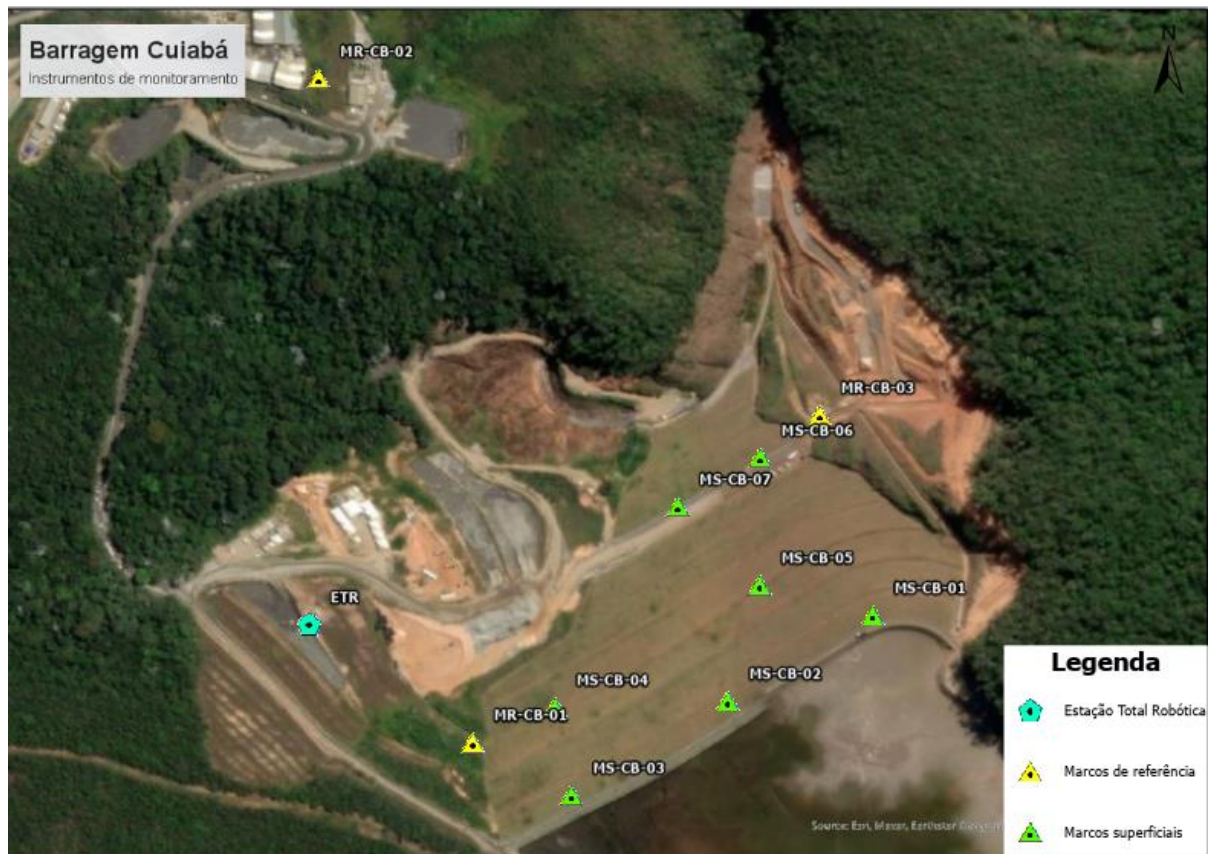
Figura 18: - Marcos Superficiais e de Referência/ETR da Barragem Cuiabá
