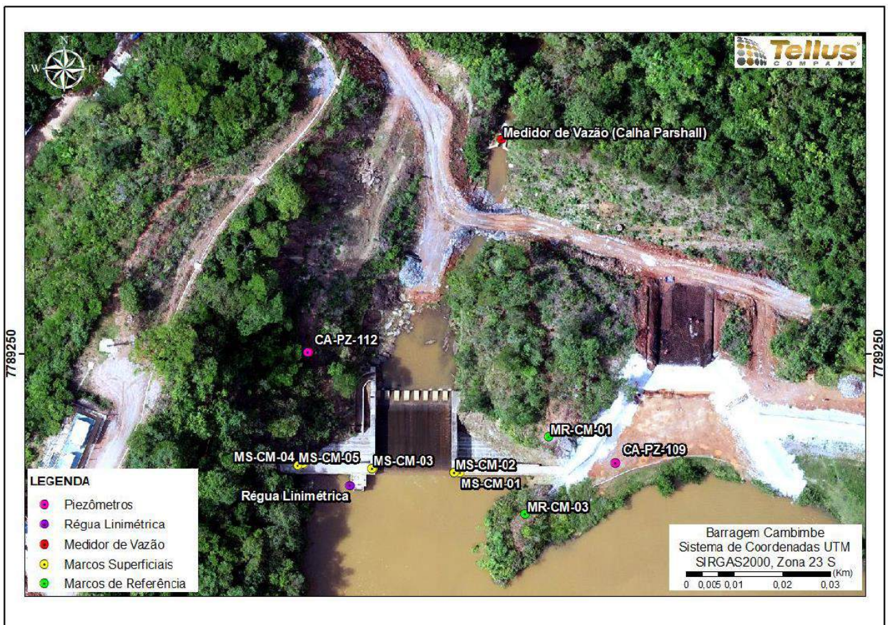
Figura 2: Mapa de Locação dos instrumentos instalados (Adaptado de AA-315-TY-0580-206-RT-0189)
