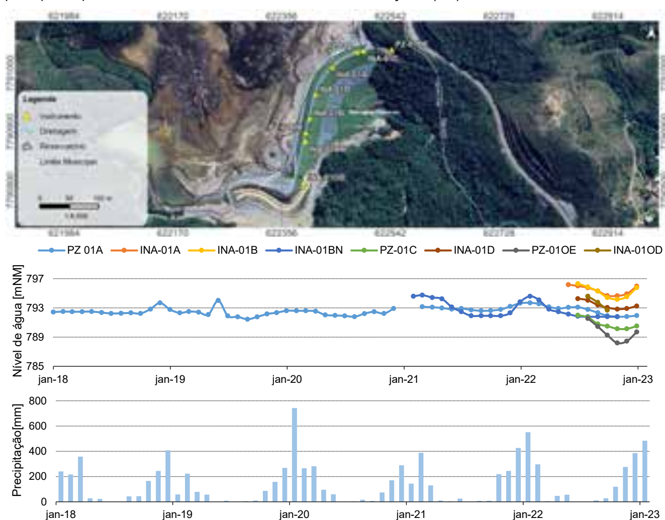
Figura 5-5: Série histórica dos instrumentos localizados na seção longitudinal da crista da barragem.
