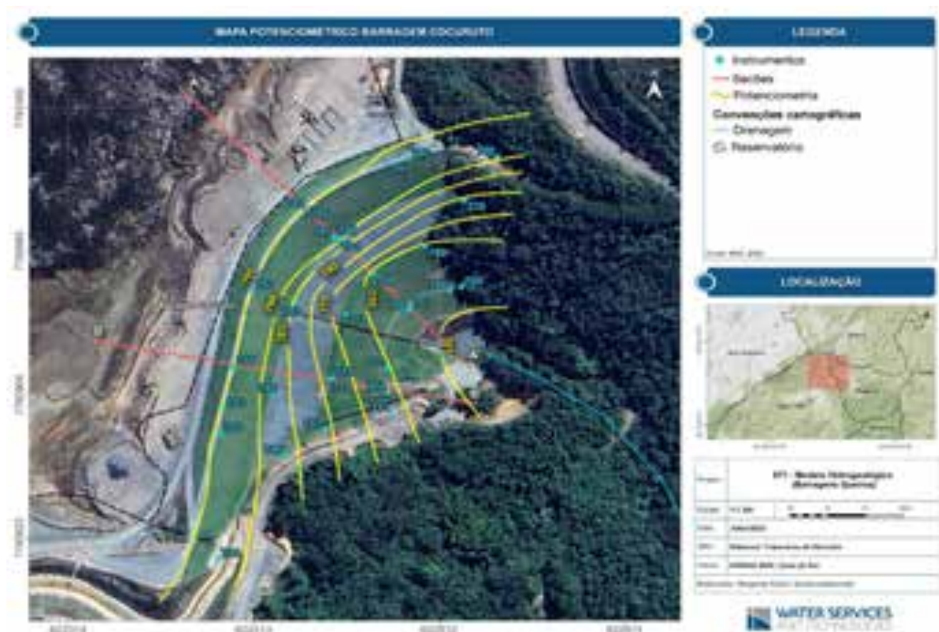
Figura 5-30: Superfície freática na região da barragem Calcinados.
