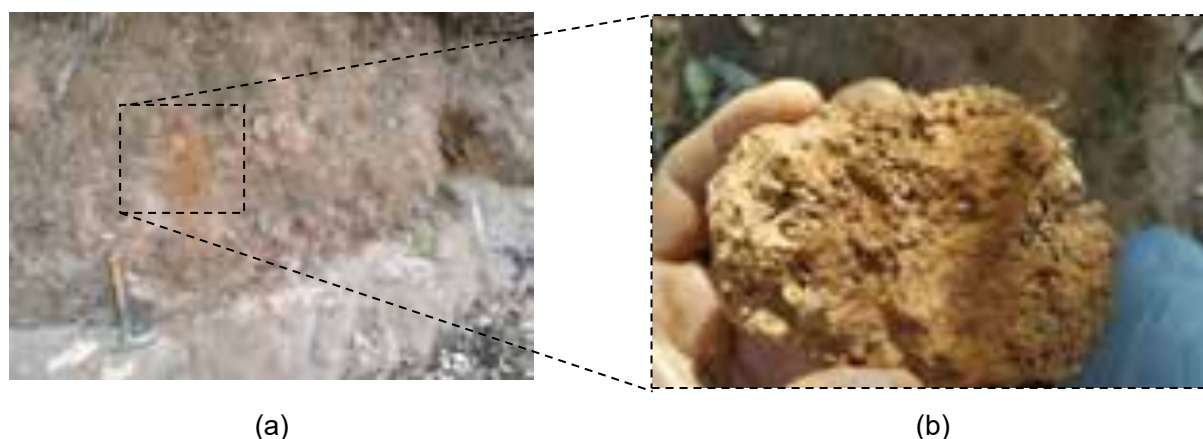
Figura 2-6: Colúvio; a) Visão do corte; b) Detalhe da amostra. Fonte: WALM (2021a).
