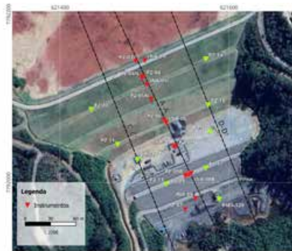
(a) Localização dos instrumentos na Barragem Calcinados.
