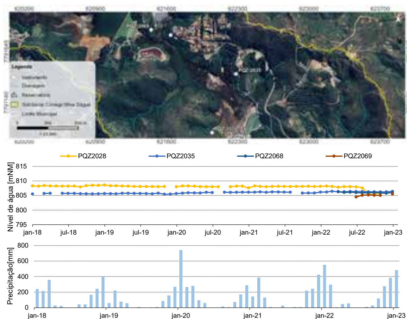
Figura 5-6: Série histórica dos instrumentos localizados na margem do reservatório.
