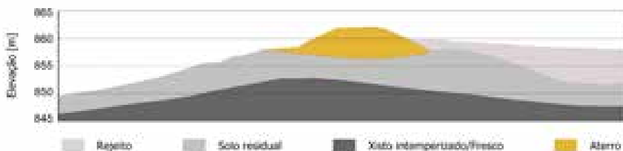
Figura 3-4: Seção esquemática do dique de sela. Fonte: Seção B-B adaptado de WALM (2021a).
