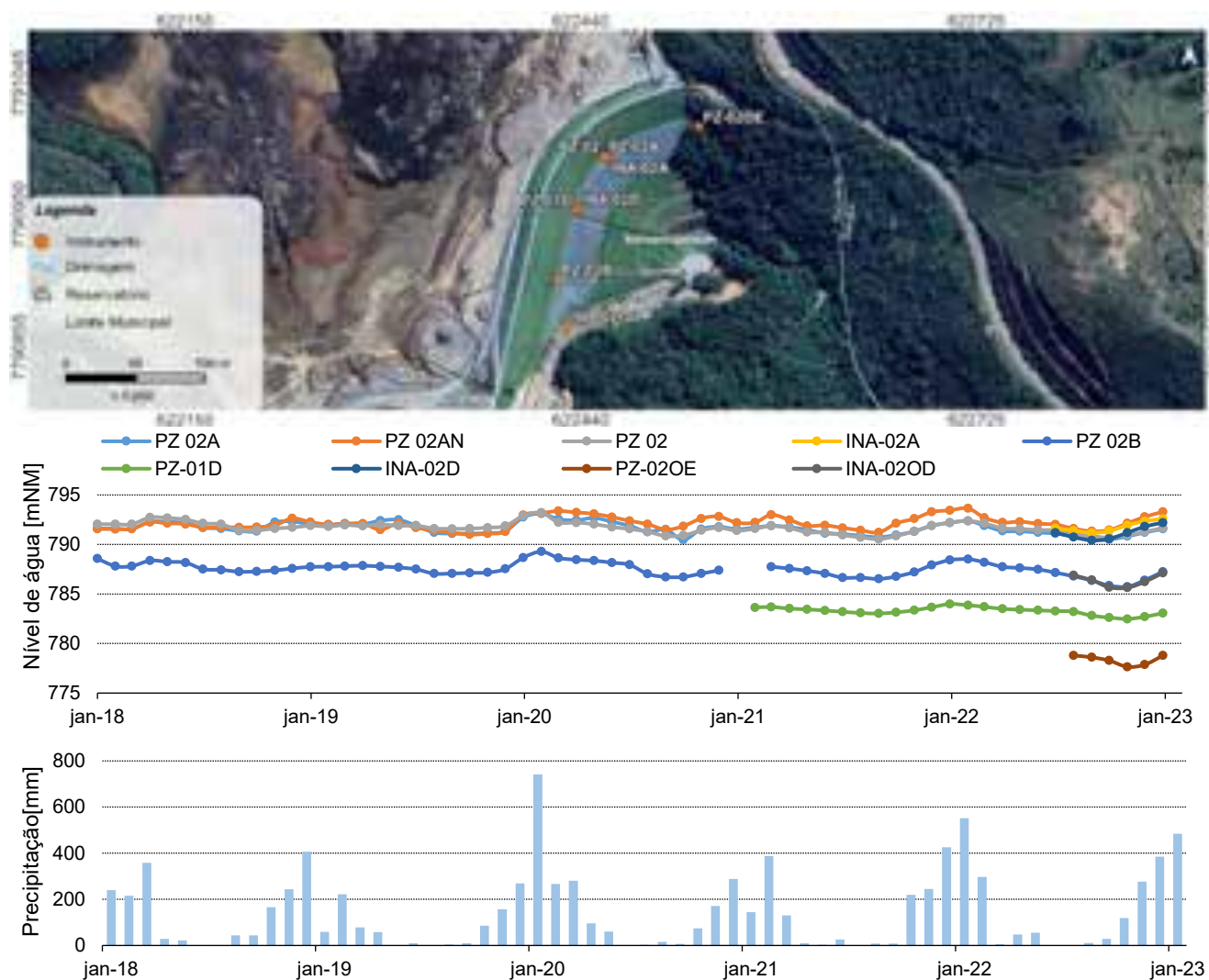
Figura 5-4: Série histórica dos instrumentos localizados na seção longitudinal de El. 795 mNM.
