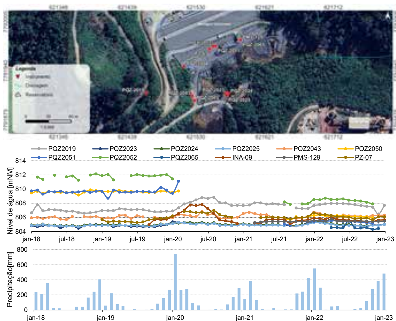
Figura 5-8: Série histórica dos instrumentos localizados a jusante da barragem Calcinados.
