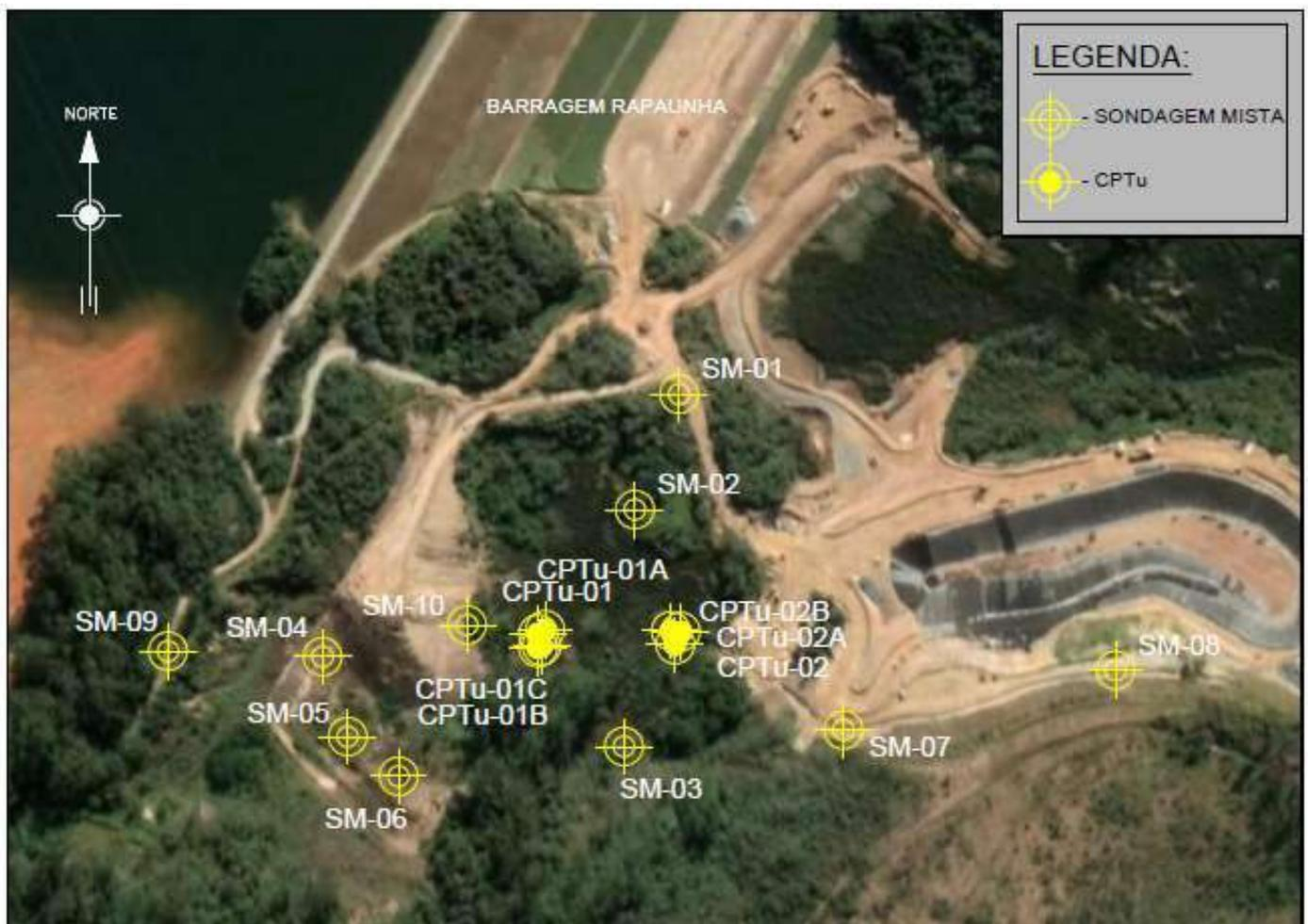
Figura 8-16- Planta de localização dos CPTu's e sondagens executadas
