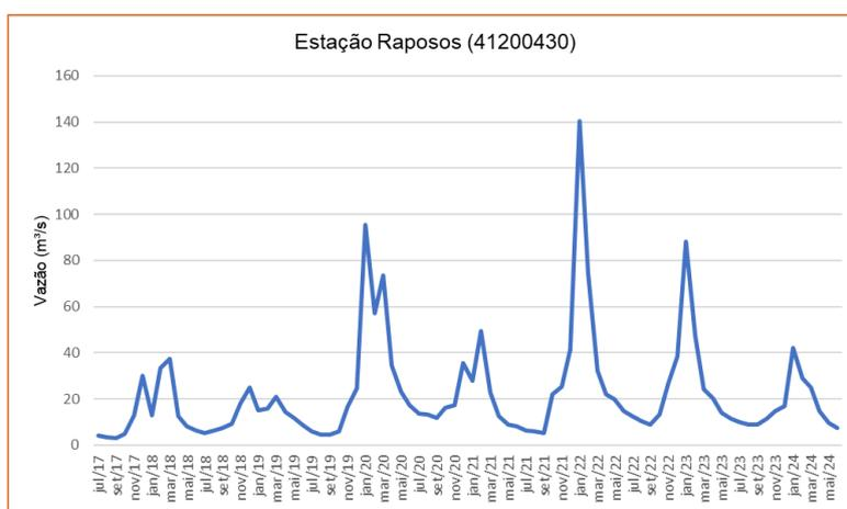
**Figura 10-46 - Evolução dos dados de monitoramento de vazão na estação fluviométrica Raposos (41200430)**
