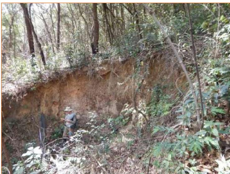
**Figura 10-33 - Exposição de perfil de latossolo nas proximidades da barragem de Rapaunha (P24)**
