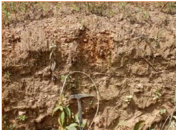
**Figura 10-31 - Cambissolo háplico identificado no entorno da Barragem de Cocuruto**
