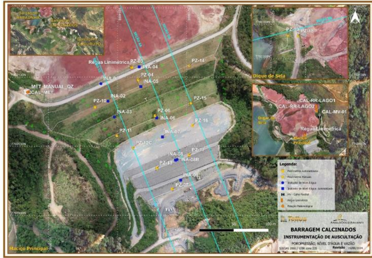
Figura 23: Localização dos Piezômetros, Indicadores de nível d'água, Medidor de Vazão, Régua e Estações Meteorológicas instalados na Barragem Calcinados.
