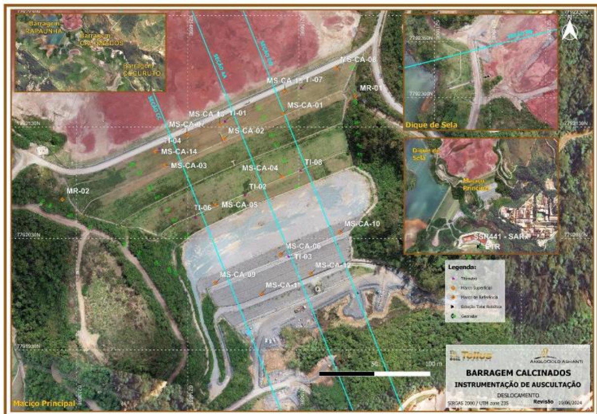
Figura 24: Marcos Superficiais e de Referência/ETR da Barragem Calcinados
