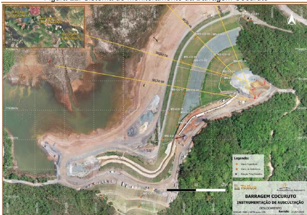
Figura 22: Sistema de Monitoramento da Barragem Cocuruto
