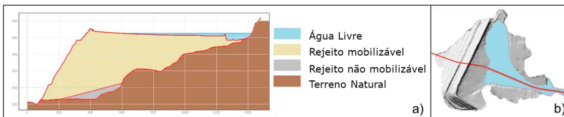
Legenda: a) Perfil das camadas do reservatório; b) Localização em planta da seção sobre a superfície do reservatório.
