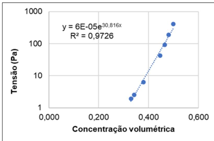
Figura 11-4 - Viscosidade em função da concentração volumétrica da mistura – Amostra AdoB585
