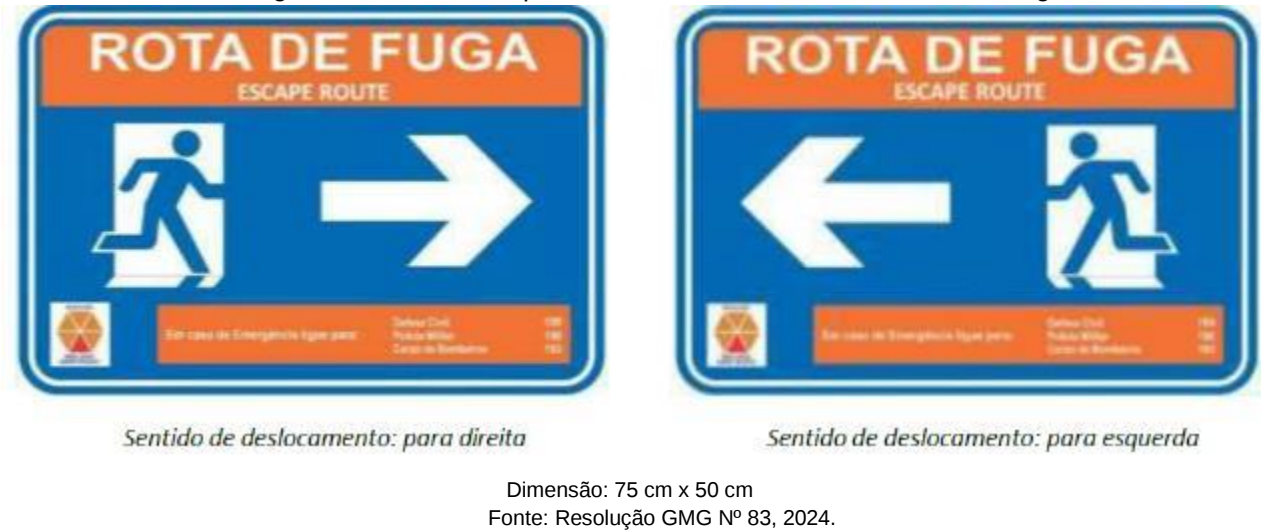
Figura 24: Modelos de placas instaladas indicativas de Rota de Fuga.
