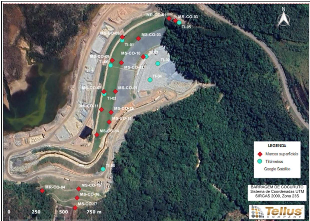
Figura 7.2 - Mapa de localização dos prismas topográficos da Barragem de Cocuruto.
