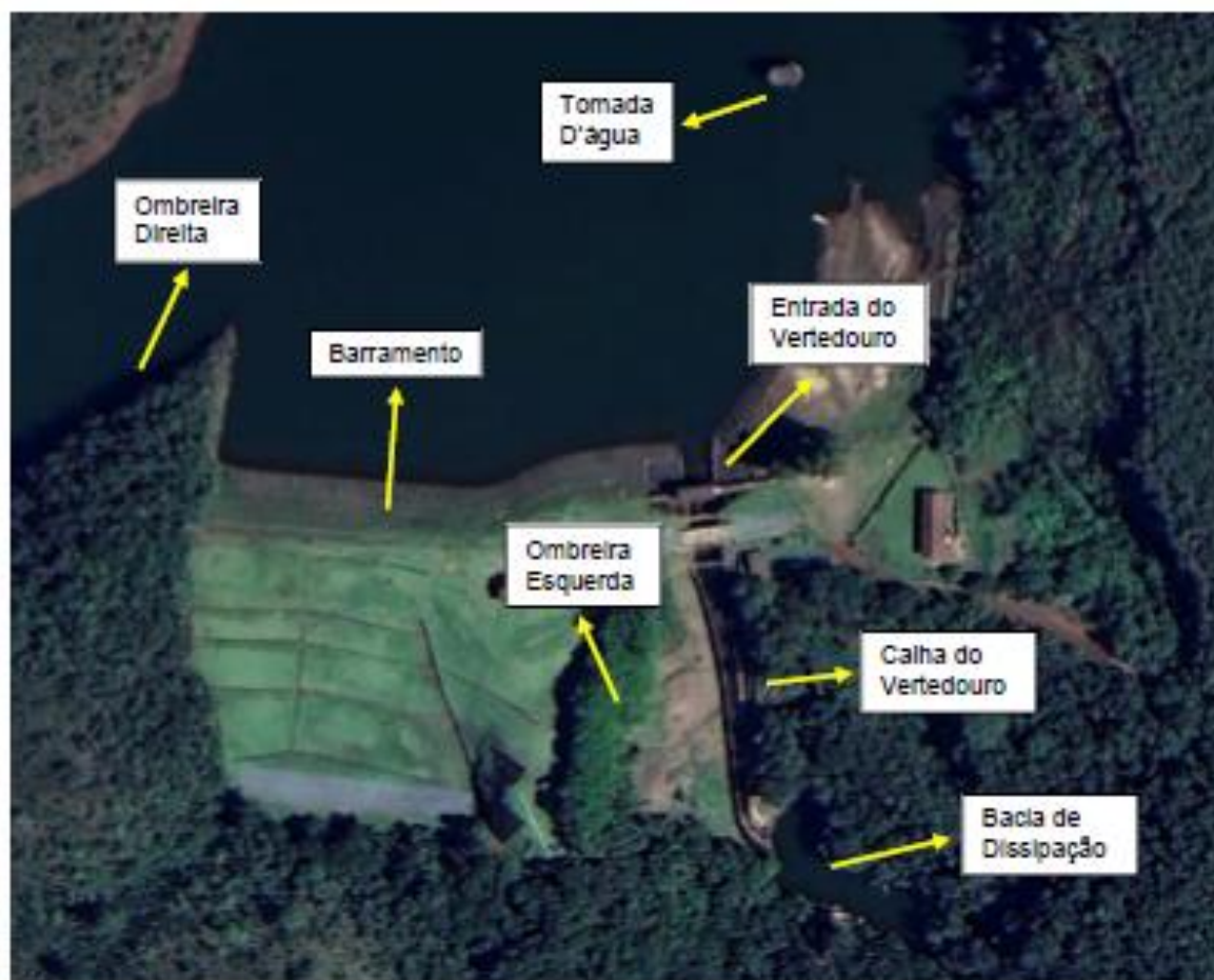
Figura 2 - Arranjo geral do barramento
