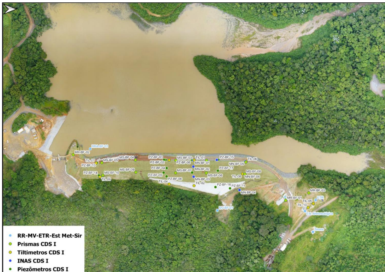
Figura 18: Sistema de Monitoramento da Barragem de Finos CDS I – Medidores
