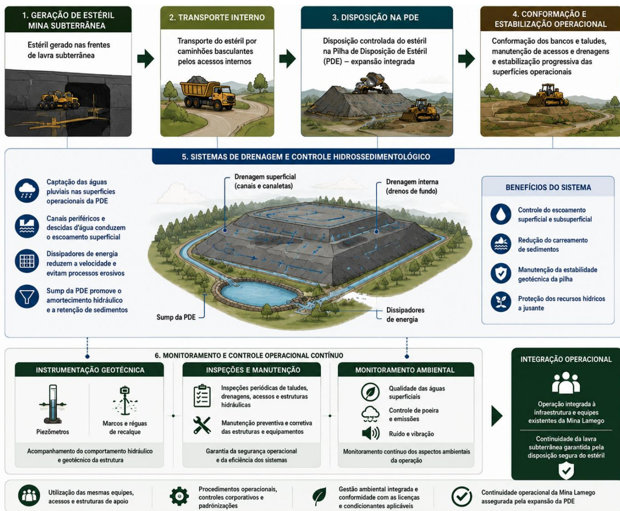
Figura 23 – Fluxograma operacional integrado da Mina Lamego e da PDE Lamego Fonte: Tema Ambiental, 2026.
