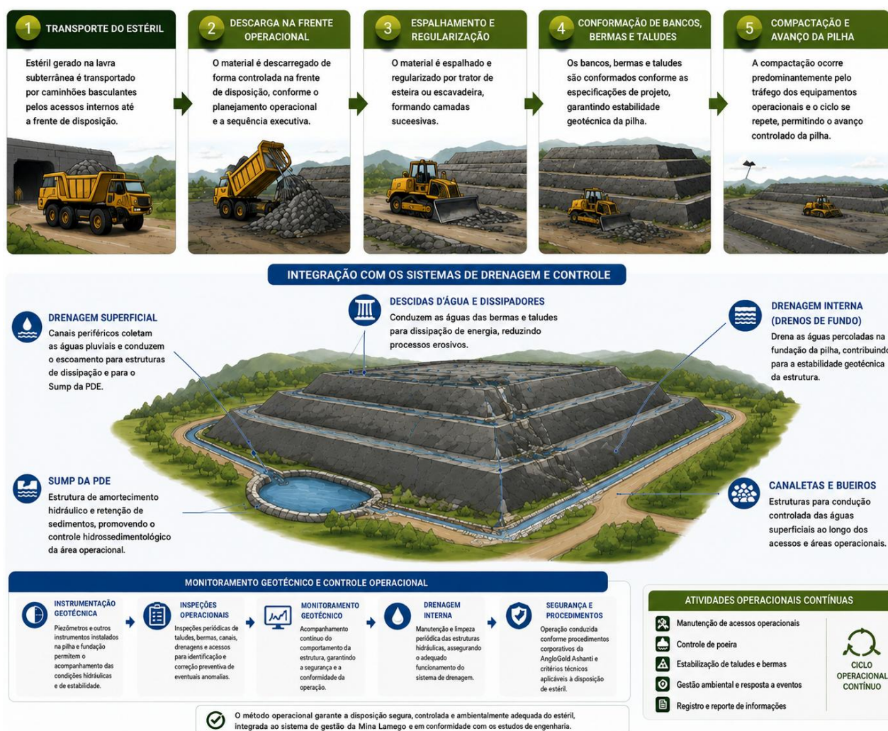
Figura 24 – Sequência operacional da disposição de estéril na PDE Lamego
