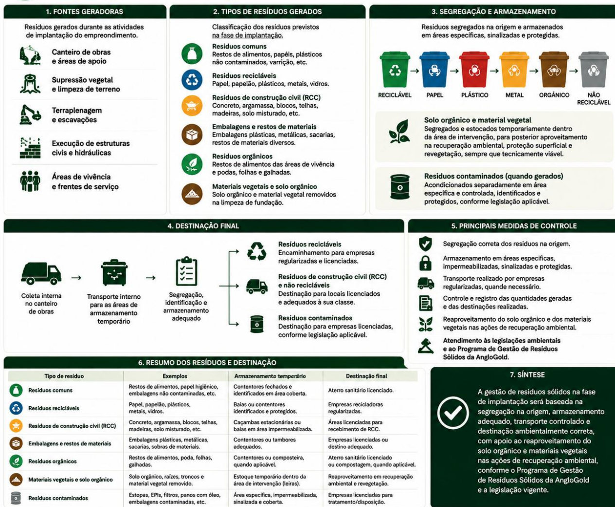
Figura 18 – Esquema da geração de resíduos sólidos e seus sistemas de controle – Fase de Implantação Fonte: Tema Ambiental, 2026.
