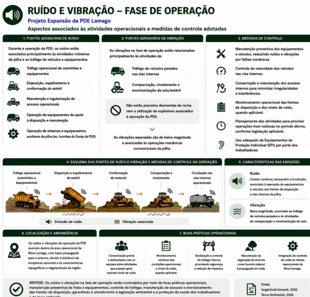
Figura 33 – Esquema da geração de ruído e vibração e seus sistemas de controle – Fase de Operação Fonte: Tema Ambiental, 2026.
