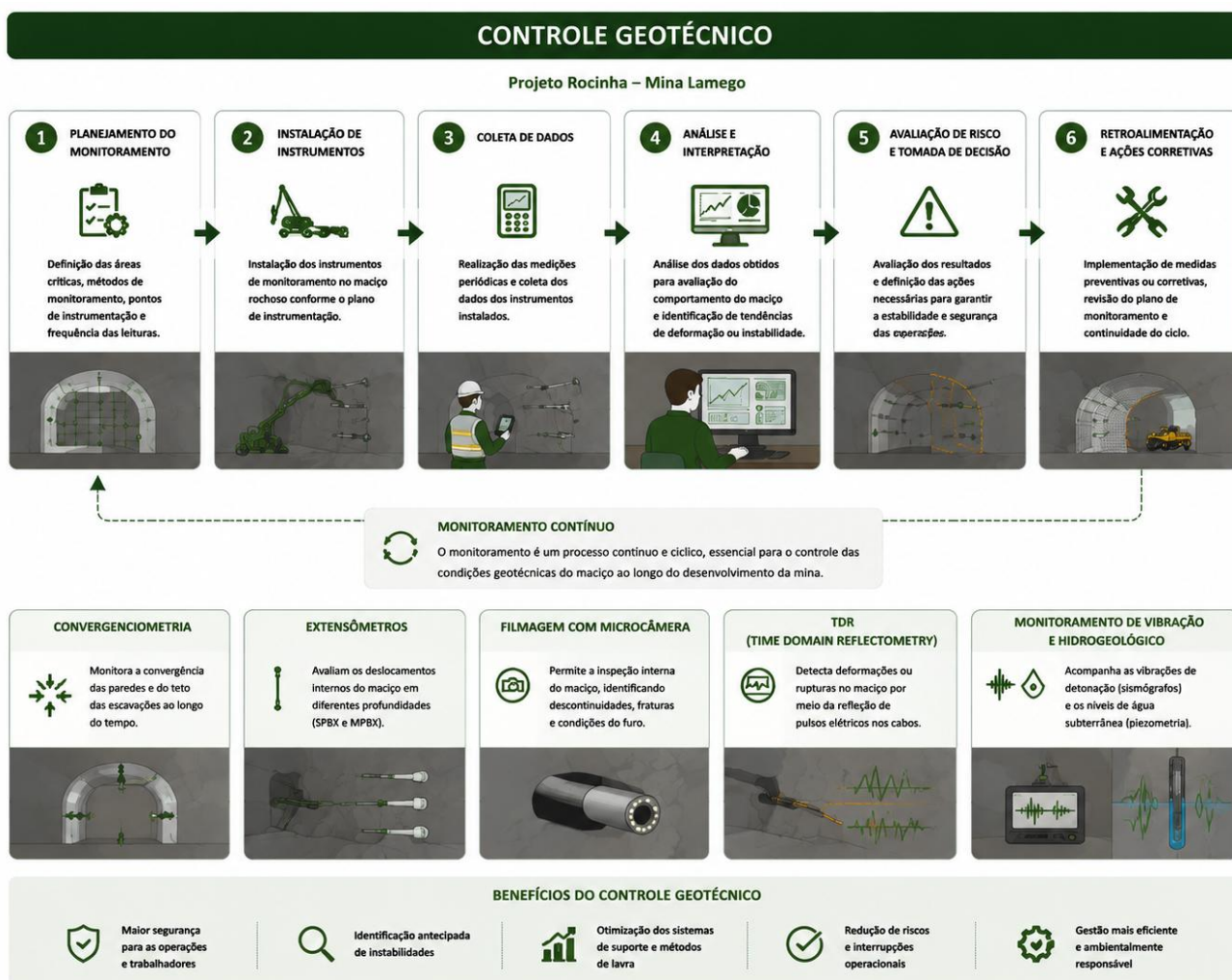
Figura 40 – Fluxo do controle geotécnico na Mina Lamego
