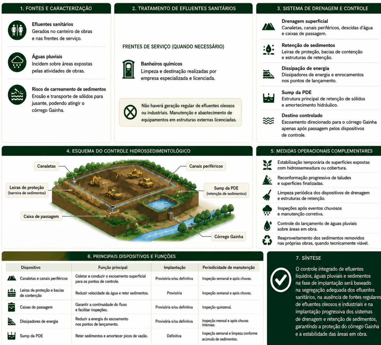
Figura 17 – Esquema da geração de efluentes líquidos, sanitários, pluviais e sedimentos e seus sistemas de controle – Fase de Implantação
