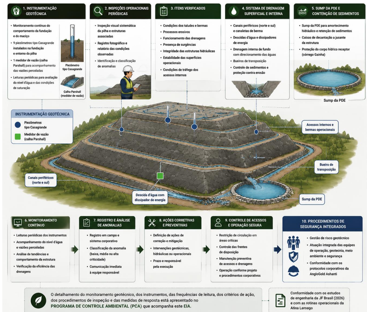
Figura 25 – Sistema de controle geotécnico e segurança operacional da PDE Lamego Fonte: Tema Ambiental, 2026.
