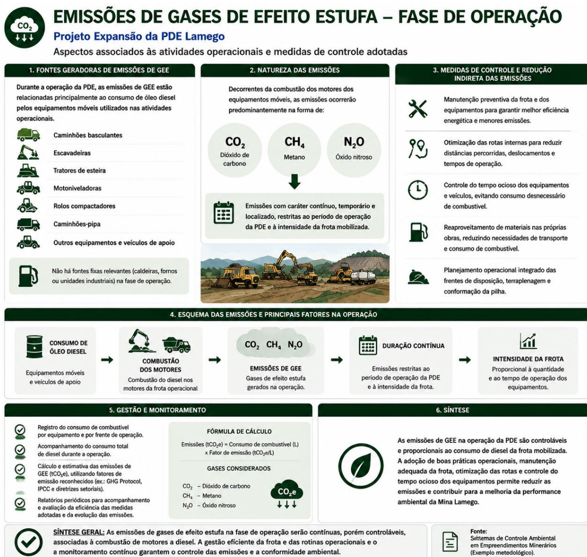
Figura 34 – Esquema da geração de Emissões de Gases de Efeito Estufa e seus sistemas de controle – Fase de Operação
