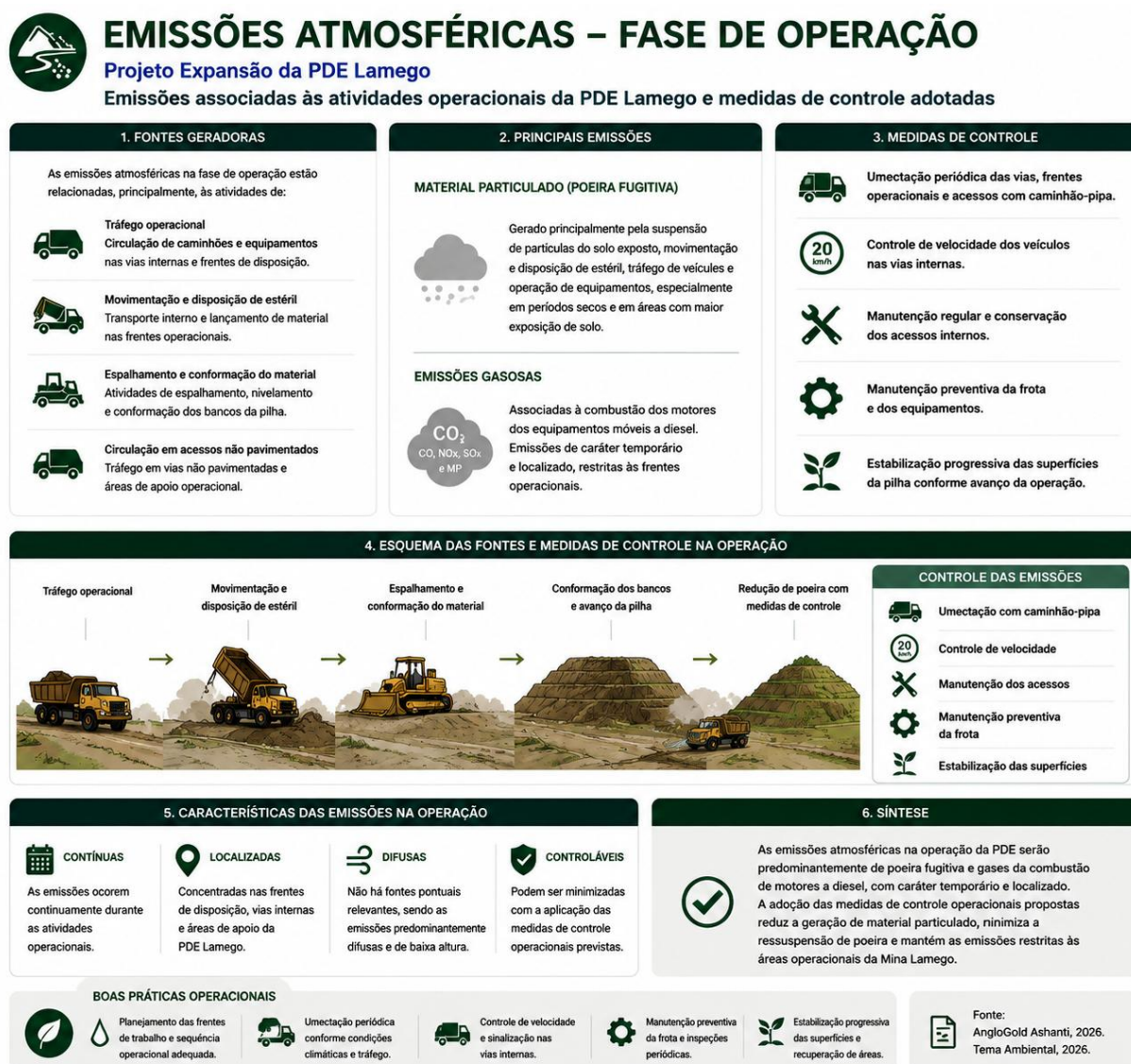
Figura 32 – Esquema da geração de emissões atmosféricas e seus sistemas de controle – Fase de Operação Fonte: Tema Ambiental, 2026.
